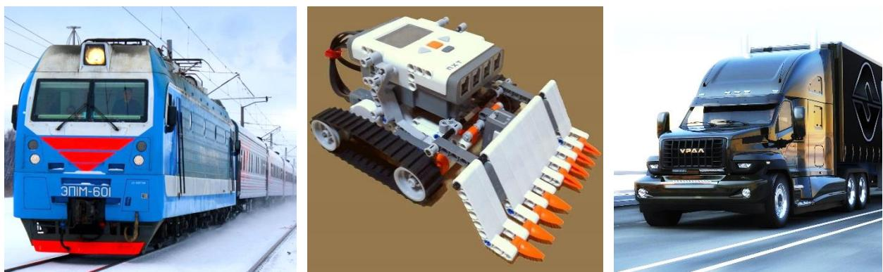
**Локомотив, трактор, тягач, грузовой автомобиль** и др. — самоходная наземная транспортная машина, предназначенная для перемещения груза, буксирования или толкания прицепов, несамоходных машин и т.п.
