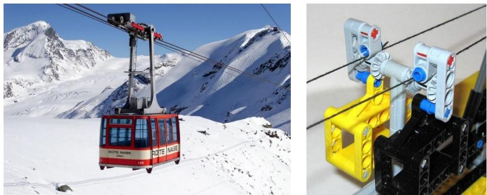
**Канатный подвес** – это транспортирующие машины, тяговым и грузонесущим элементом которых является канат, подвешенный на опорах над поверхностью земли
